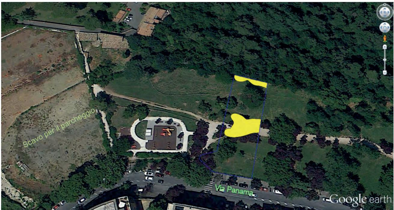
Fig. 17 – Schema preliminare della suscettibilità da collasso dell'area test, desunta dai risultati dalle prospezioni geofisiche multidisciplinari (in giallo le aree a maggior suscettibilità da sprofondamento; la linea blu delimita il perimetro dell'area test). A Est del sito è visibile lo scavo realizzato per il parcheggio.
